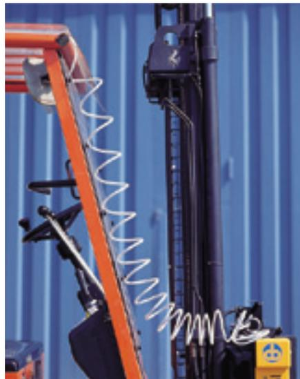
Esempio di collegamento del terminale alla piastra di pesatura del carrello con cavo a spirale, consigliato per una/due mandate
