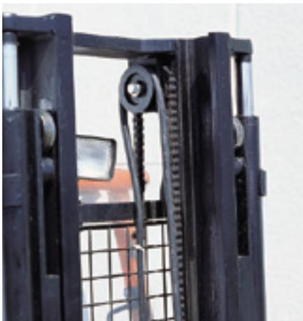
Esempio di collegamento del terminale alla piastra di pesatura del carrello con sistema a carrucola per due/tre mandate
