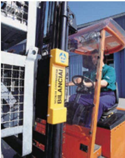
Particolare del carter laterale a protezione delle cerniere e delle celle di carico
